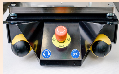
AZIONAMENTO A DUE MANI Safeball ergonomiche (o facoltativamente con tasto)
