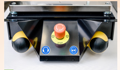
DÉCLENCHEMENT BIMANUEL Safeballs ergonomiques (ou en option avec bouton)
