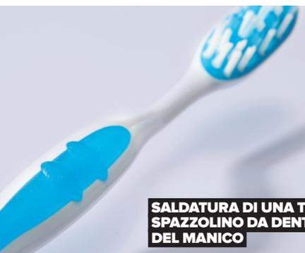
**SALDATURA DI UNA TESTA DI SPAZZOLINO DA DENTI E DEL MANICO**
